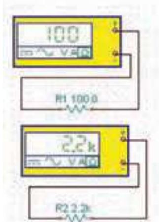
شکل ۹۰-۲ اندازه گیری مقاومت اهمی
