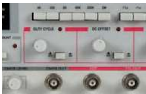
شکل ۲-۱۰۴- تعدادی دیگر از ولوم‌ها و سلکتورهای سیگنال ژنراتور برای کاربردهای ویژه
