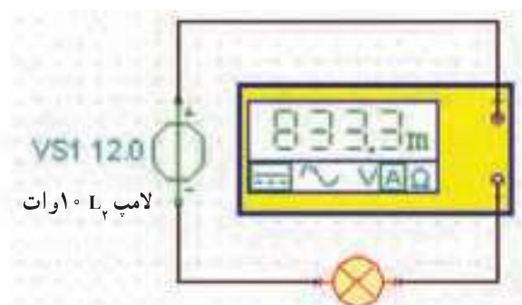
شکل ۹۵-۲ اندازه‌گیری جریان یک لامپ ۱۲ ولتی ۱۰ وات
