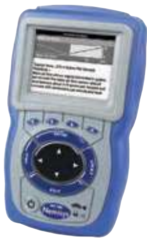
شکل ۱۳۳-۲ یک نمونه دستگاه اسکنر (scanner) خودرو را نشان می‌دهد، که در آن از اسیلوسکوپ استفاده شده است.
