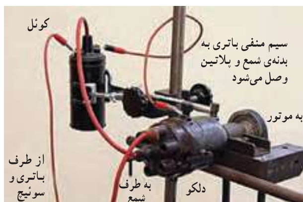
شکل ۱۴۴-۲ مدار شبیه‌سازی شده‌ی سیستم جرقه‌زنی
