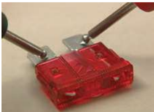
شکل ۸۱-۲ اتصال فیوز به اهم‌تر
