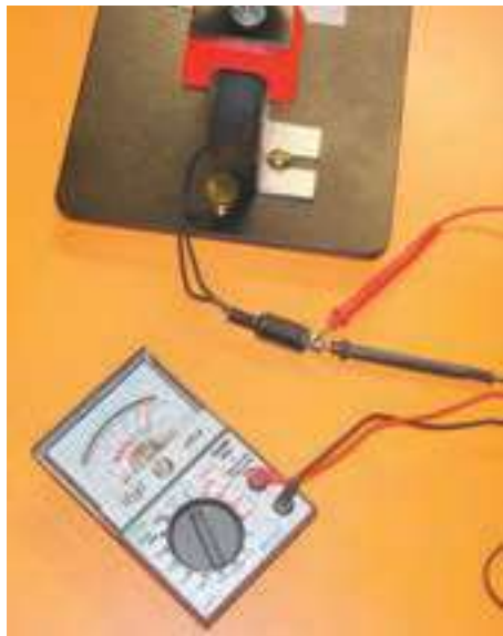
شکل ۸۴-۲ ج- آزمایش به وسیله اهم متر عقربه ای
