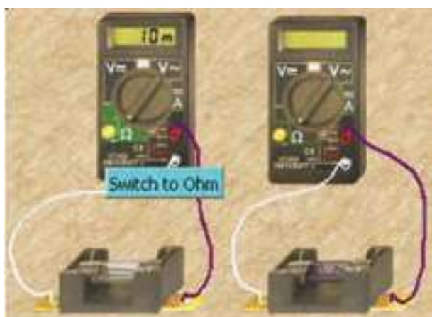
شکل ۸۱-۲ اتصال فیوز به اهم‌تر
