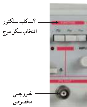
شکل ۲-۱۰۱ کلید سلکتور انتخاب شکل موج
