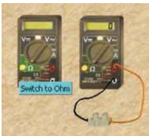
الف — مقدار مقاومت بی نهایت است ب — مقدار مقاومت صفر است
