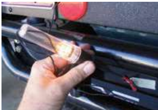
شکل ۸۶-۲- استفاده از تستر لامپی
