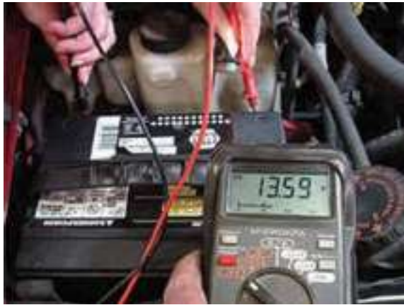
شکل ۱-۵۰ اندازه‌گیری ولتاژ با ولت‌متر دیجیتال
