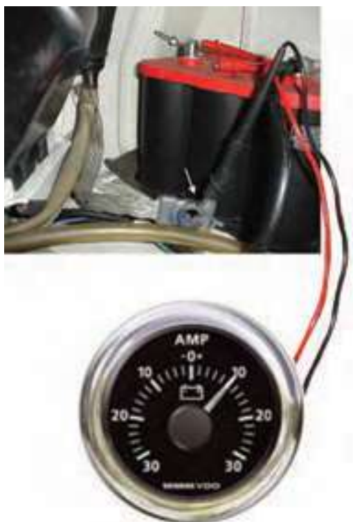
شکل ۱-۵۲ اتصال آمپر متر به صورت سری
