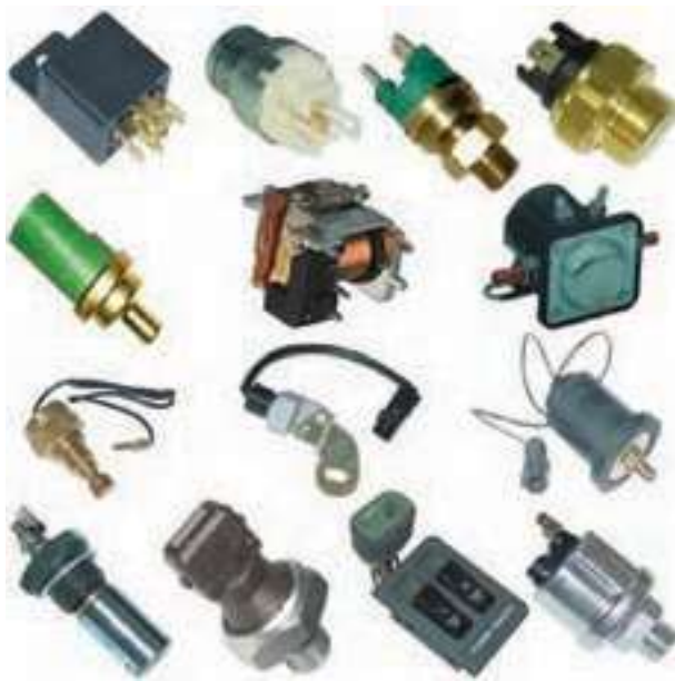
شکل ۱۸۸-۲: چند نمونه حسگر و عملگر برگزیده در خودرو
