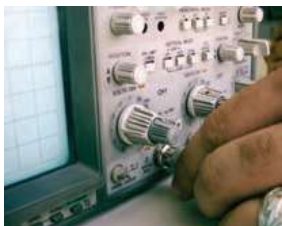
شکل ۱۱۴-۲ نحوه‌ی اتصال BNC به اسیلوسکوپ
