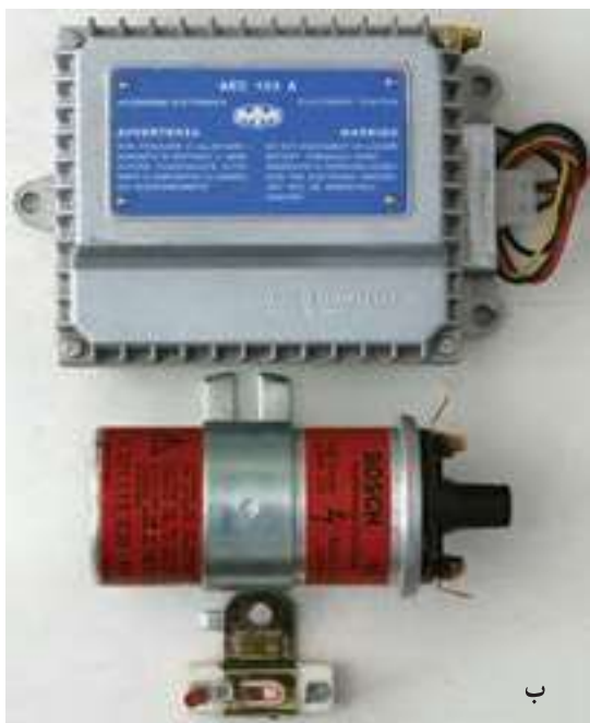
شکل ۱۴۶-۲ دو نمونه سیستم الکترونیکی جرقه‌زنی قابل نصب روی انواع خودروها
