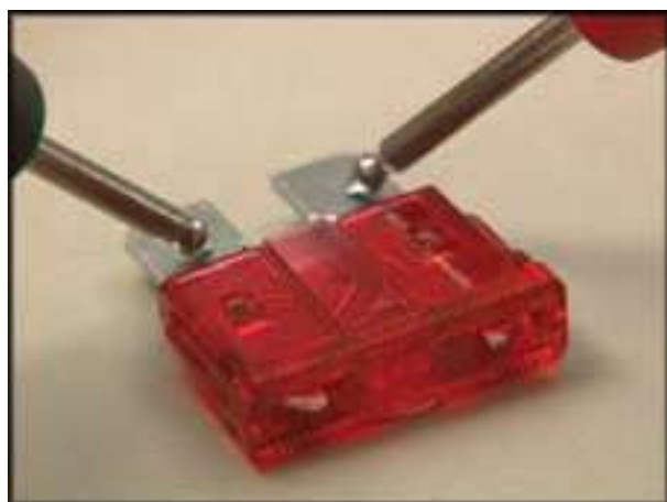
شکل ۱-۴۴ آزمایش فیوز توسط اهم‌متر
