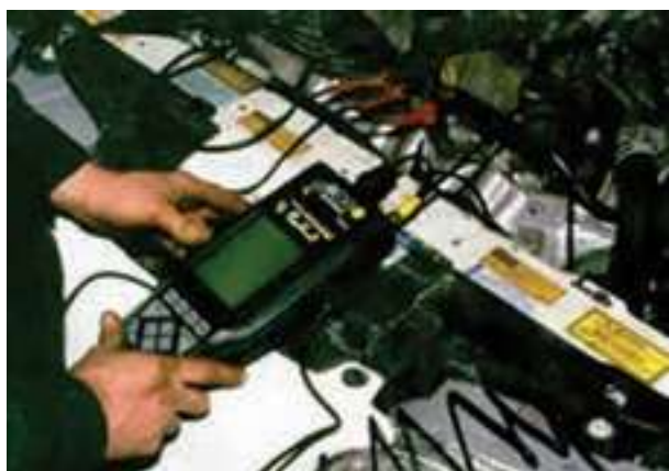
شکل ۲-۱۹۴- یک نمونه دستگاه اسکینر کوچک دستی
