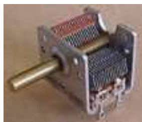
خازن متغیر قابل تنظیم با محور
