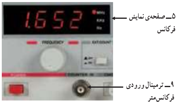
شکل ۲-۱۰۳- فرکانس متر و ترمینال ورودی آن
