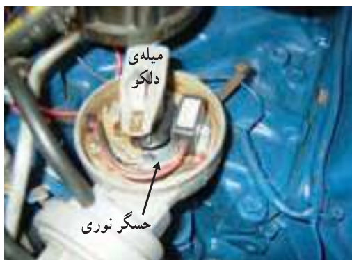
شکل ۱۴۵-۲ سه نمونه حسگر استفاده‌شده در سیستم جرقه‌زنی
