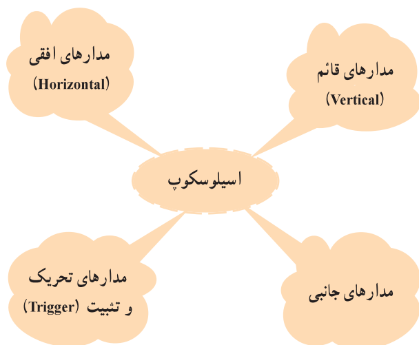
شکل ۲-۱۲۰ - مدارهای موجود در اسیلوسکوپ
