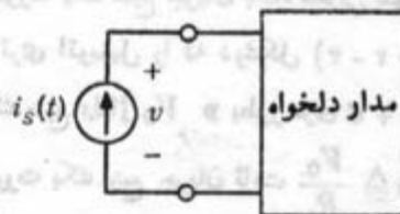
شکل ۵-۲ - منبع جریان فابسته که بیک مدار
