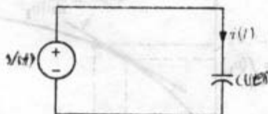
شکل ۳-۷- یک خازن خطی تغییرپذیر بازمان که بوسیله منبع ولتاژ مینوسی تحریک میشود .
