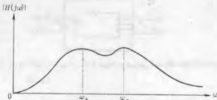
شکل ۹-۱- منحنی اندازه نوعی یک مدار تطبیق شده مضاعف
