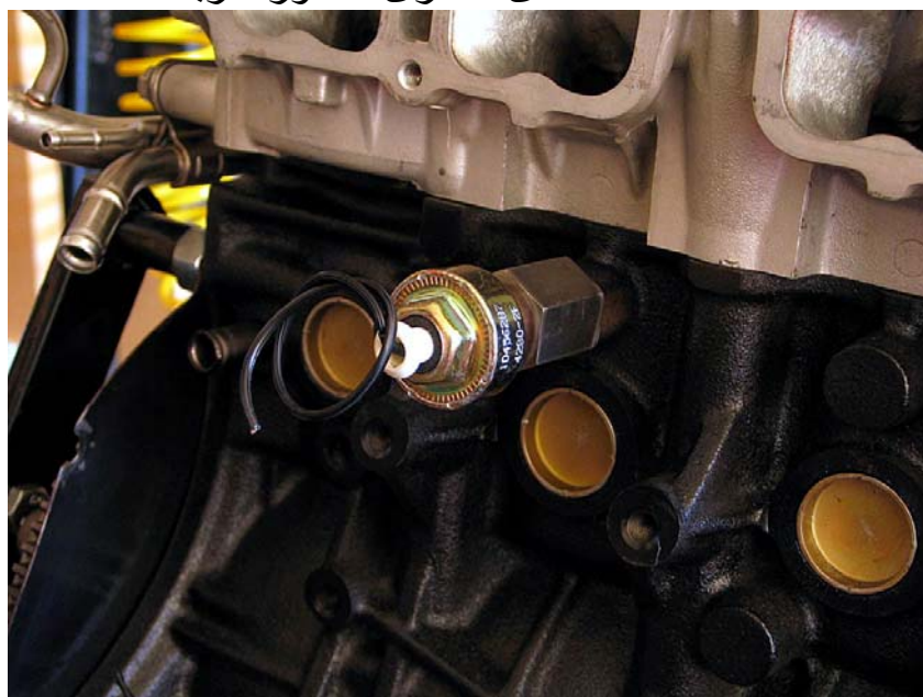
شکل ۶-۳۲. نوعی از سنسور ضربه و محل قرارگیری آن
