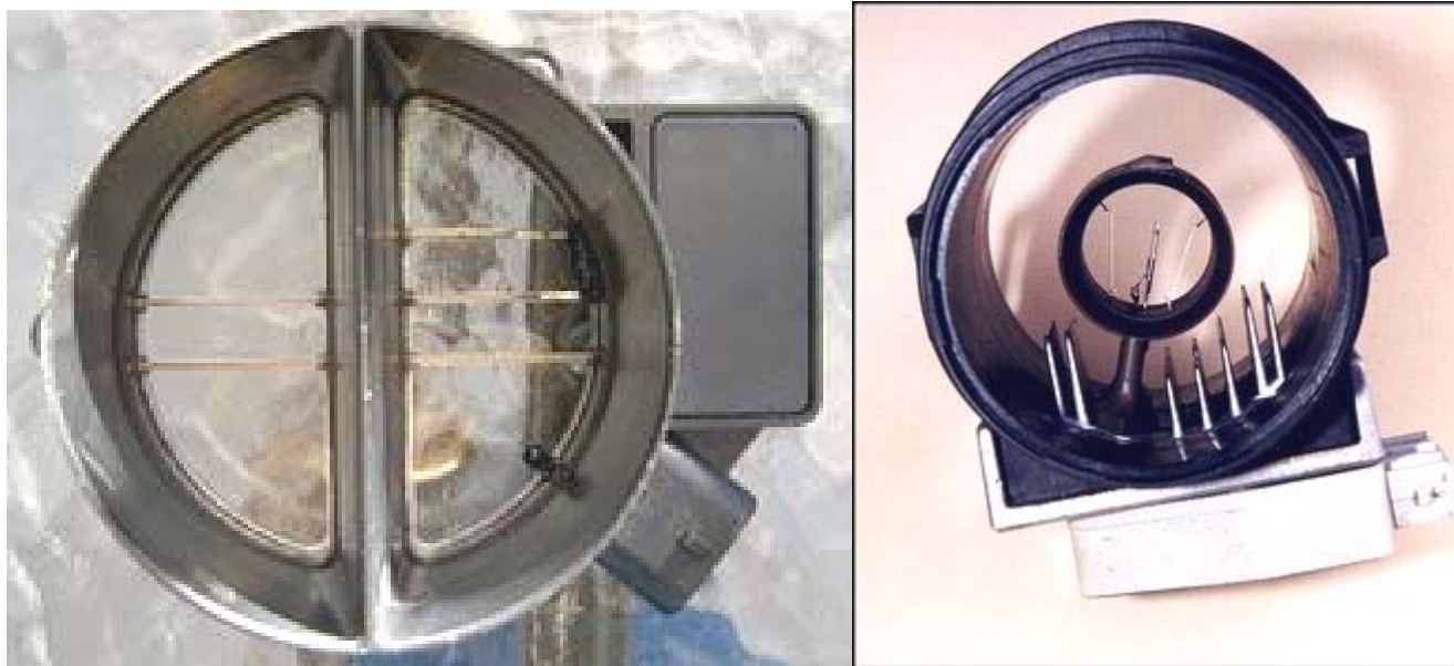
شکل ۱۷-۶- اجزای داخلی دو نمونه از سنسور جریان هوای سیم داغ (MAF)
