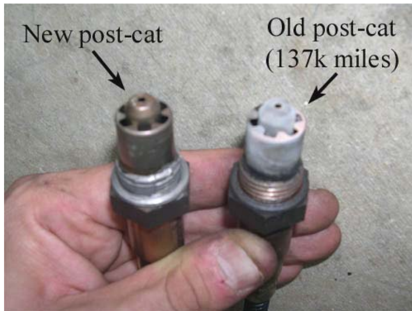
شکل ۲۵-۶- مقایسه ظاهری سنسور اکسیژن نو و کارکرده
