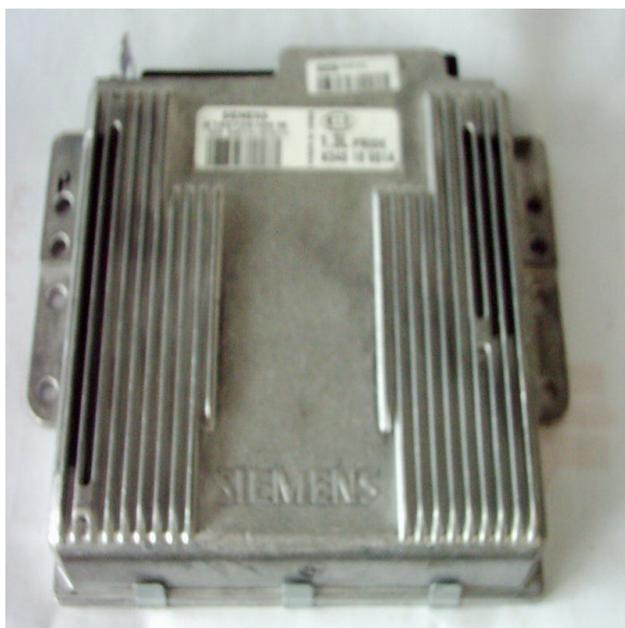
ECU به کار رفته در این سیستم ها از نوع SAGEM یا SIEMENS می باشد که با استفاده از این ECU و این سیستم، مقدار سوخت از 7.5 لیتر در 100 کیلومتر در سیستم کیا به 6.5 لیتر در 100 کیلومتر در سیستم های زیمنس و ساژم رسیده است. ECU در سمت چپ پای راننده قرار دارد.
