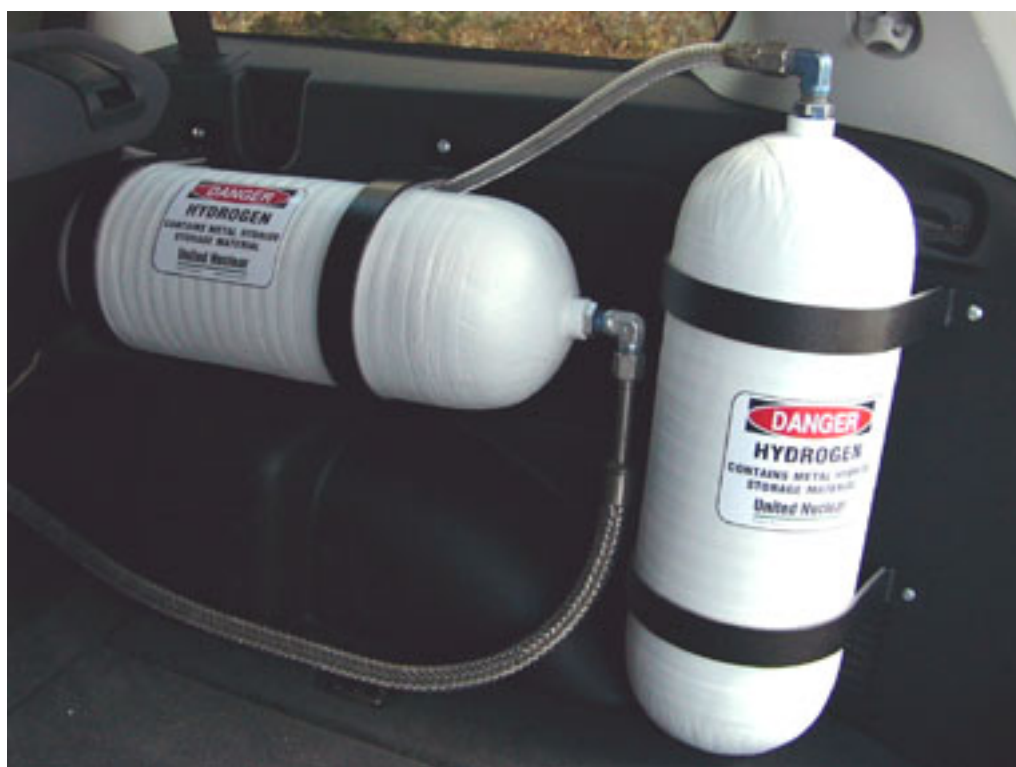
شکل ۲۳-۱- محل قرارگیری مخازن هیدروژن در خودروی میتسوبیشی
