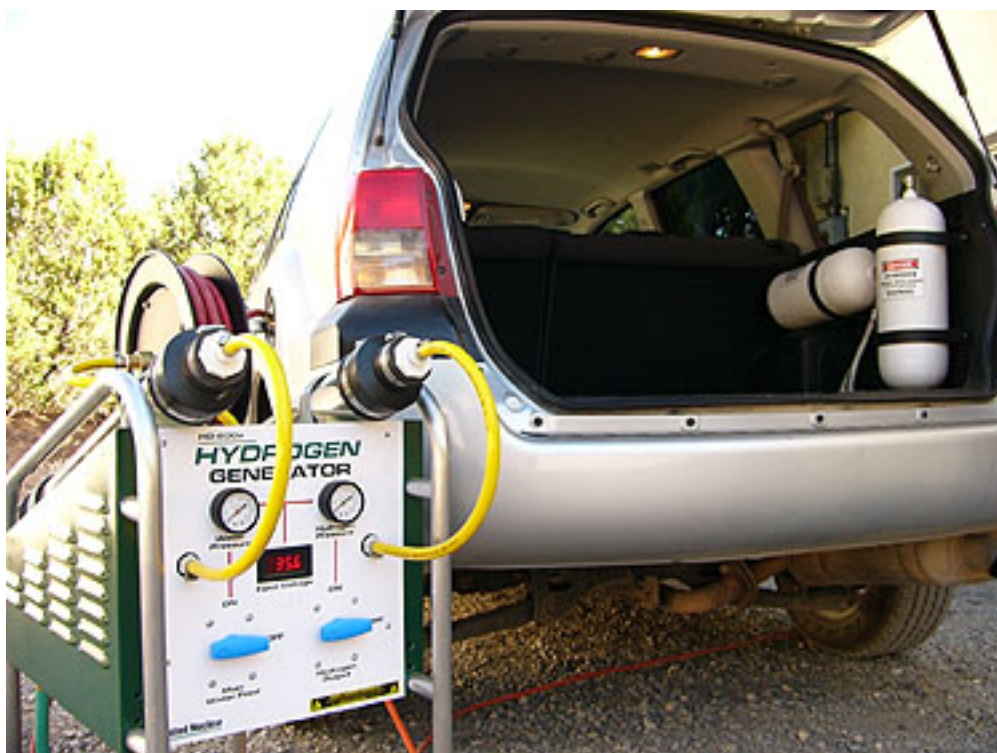
شکل ۱۹-۱- ژنراتور برای سوخت گیری مخازن هیدروژن تعبیه شده در خودرو
